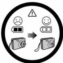
如偶然遇到电池耗电结束但镜头尚未完全收回状况时，更换充满电的电池即可，并注意保护镜头，避免撞击磕碰。
