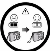
如偶然遇到电池耗电结束但镜头尚未完全收回状况时，更换充满电的电池即可，并请注意保护镜头，避免撞击磕碰。
